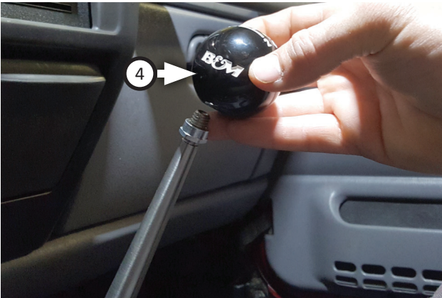
24. Thread shift knob (4) onto shifter stem.
